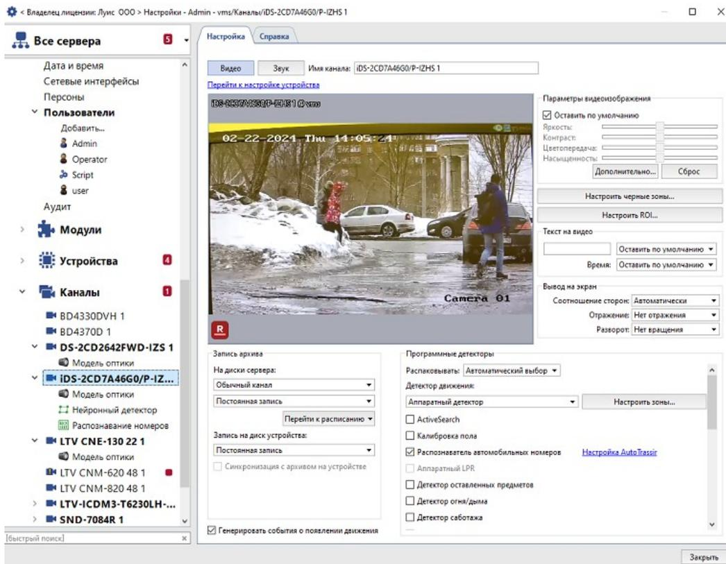
**Рис. 4. Добавление детекторов аналитики на сервере Trassir**
